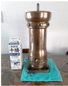
【ボイラー安全弁】
